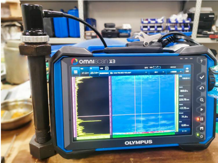
Figura 1 Rilevatore di difetti OmniScan X3 collegato alla sonda anulare phased array posizionata su un bullone
